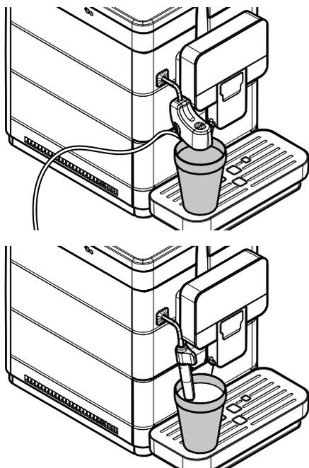
Appuyer sur la touche « Manual milk » pour démarrer la préparation du lait chaud. La machine nécessite une certaine durée de préchauffage. Une fois le préchauffage effectué, la machine commence à distribuer du lait émulsionné ou de la vapeur.
