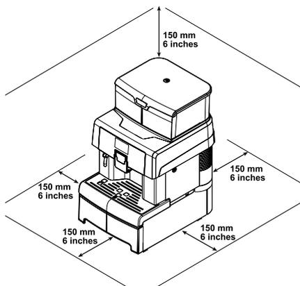
**⚠** Magnetfelder oder in der Umgebung aufgestellte Elektrogeräte, die Störaussendungen vorweisen, können Betriebsstörungen der elektronischen Steuerung an der Maschine verursachen. Bei Temperaturen um 0°C besteht Frostgefahr für die Wasser enthaltenden Bestandteile. Die Maschine sollte unter diesen Bedingungen nicht betrieben werden.
