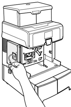
Distanzstück auf der linken Seite der Maschine anbringen und mit den 4 im Lieferumfang enthaltenen Schrauben befestigen.
