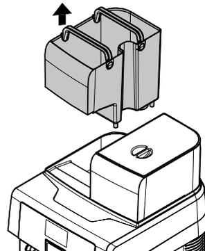
Ausspülen und mit frischem Wasser füllen; der im Tank angegebene maximale Füllstand (MAX) darf nicht überschritten werden.
