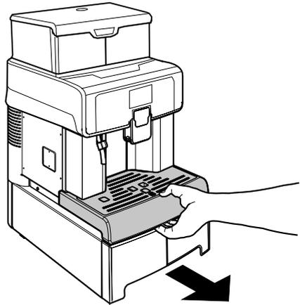
Die Abtropfschale leeren und reinigen.
