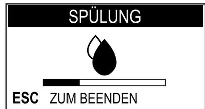
Warten, bis dieser Zyklus automatisch beendet wird; Die Ausgabe kann durch Druck der Taste „ESC“ abgebrochen werden.
