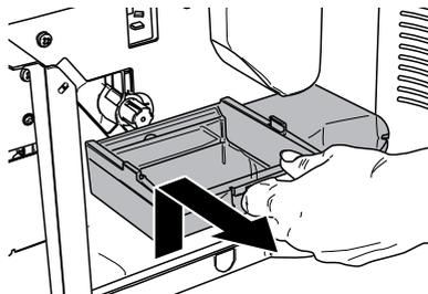
Den internen Behälter herausnehmen, reinigen und wieder in die entsprechende Aufnahme einsetzen.
