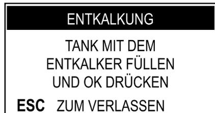
Den Wassertank mit Wasser und dem Entkalkungsmittel bis zur Füllstandmarkierung CALC CLEAN an der hinteren Seite des Tanks füllen.
