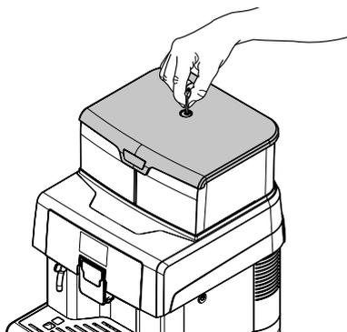
Nach der Entriegelung wird die Abdeckung durch Anheben entfernt.
