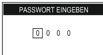
👉 Wenn innerhalb von wenigen Sekunden kein Passwort eingegeben wird, kehrt die Maschine zur vorherigen Ansicht zurück.
