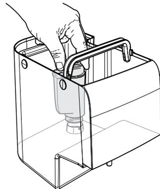
Den Tank mit frischem Trinkwasser füllen und wieder in die Maschine einsetzen.
