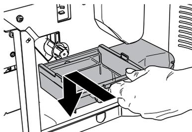
☞ Wenn der Behälter eingesetzt wird, ist die Vorgehensweise zur Herausnahme in umgekehrter Reihenfolge auszuführen.
