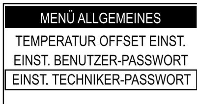
Die Taste „ESC“ mehrmals drücken, um die Funktion zu verlassen; Ab diesem Zeitpunkt ist die Eingabe des PASSWORTS erforderlich, um das Techniker Menü zu öffnen.
