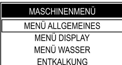
Die Taste „DOWN“ drücken, bis die Option „MENÜ WASSER“ angewählt werden kann. Zum Fortsetzen die Taste „OK“ drücken.
