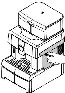
Die Brühgruppe herausnehmen, indem sie am entsprechenden Griff gehalten und die Taste «PRESS» gedrückt wird. Die Brühgruppe darf ausschließlich mit lauwarmem Wasser ohne Reinigungsmittel gereinigt werden.
