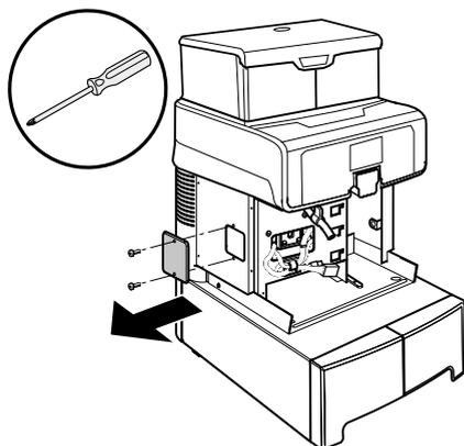
Die Kabel wie in der Abbildung anordnen und das längste Kabel durch die Öffnung führen.
