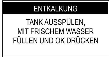
Den Wassertank sorgfältig ausspülen und bis zur Füllstandmarkierung MAX an der hinteren Seite des Tanks mit frischem Trinkwasser füllen.
