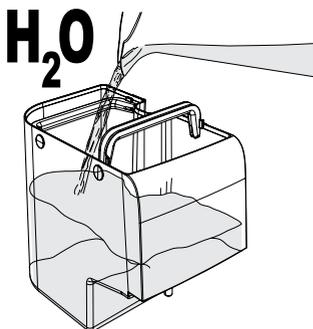
Zum Füllen des Wassertanks sollten sterile Einmalhandschuhe verwendet werden, um bakteriologische Verunreinigungen zu vermeiden.
