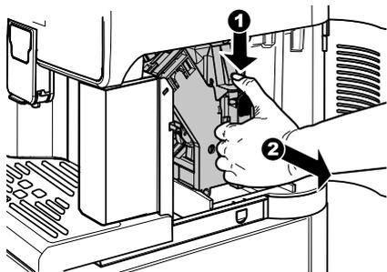
Die Brühgruppe mit lauwarmem Wasser reinigen; den oberen Filter sorgfältig reinigen. Bevor die Brühgruppe in ihre Aufnahme eingesetzt wird, ist sicherzustellen, dass kein Wasser in der Brühkammer verblieben ist.
