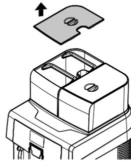
Den Tank entfernen; dieser wird an den im Inneren angebrachten Handgriffen angehoben.
