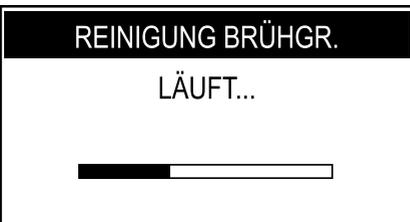
Der Zyklus wird von der Maschine automatisch beendet.
