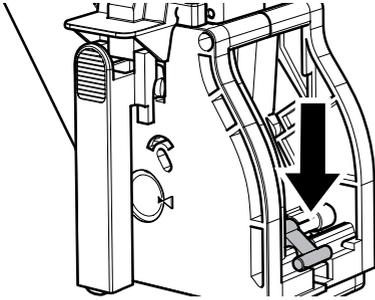
Sicherstellen, dass sich der Haken für die Sperre der Brühgruppe in der korrekten Position befindet; Um deren Position zu überprüfen, muss die Taste "PRESS" fest gedrückt werden.
