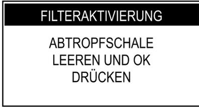
Die Abtropfschale entfernen und entleeren.
