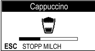
In dieser Phase gibt die Maschine die aufgeschäumte Milch aus. Die Ausgabe kann durch Druck der Taste „Cappuccino“ oder „ESC“ beendet werden.
