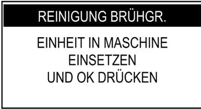
Die Brühgruppe wieder in die Maschine einsetzen und mit der Taste „OK“ bestätigen.
