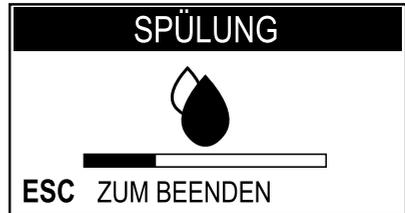
Der Balken zeigt den Fortschritt an und dass die Maschine den Spülzyklus des Systems ausführt.
